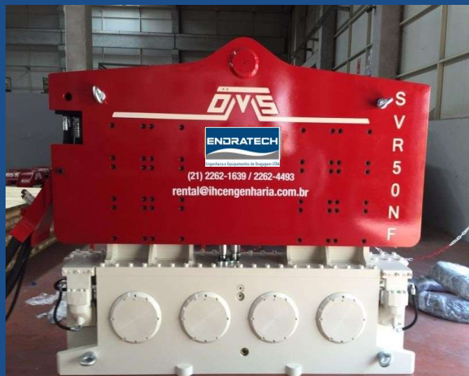
Martelo vibratório de 50 kgm de momento excêntrico
