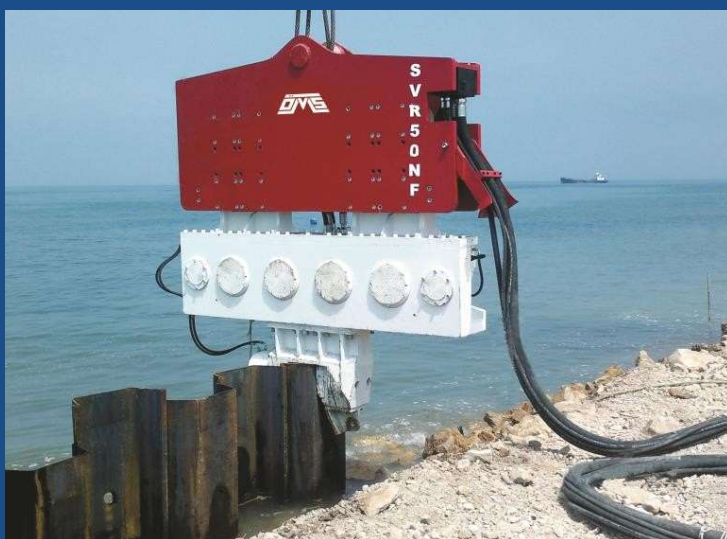
Martelo vibratório de 50 kgm de momento excêntrico
